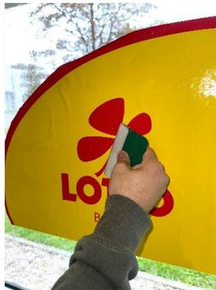
5. Die Oberfläche des Klebmotivs und den Filz der **Rakel** anfeuchten und anschließend das Wasser unter der Folie mit Hilfe der **Rakel** herausstreichen.
